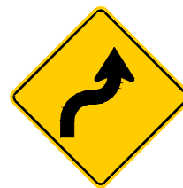
Curva Acentuada em "S" à Direita (A-4b)
